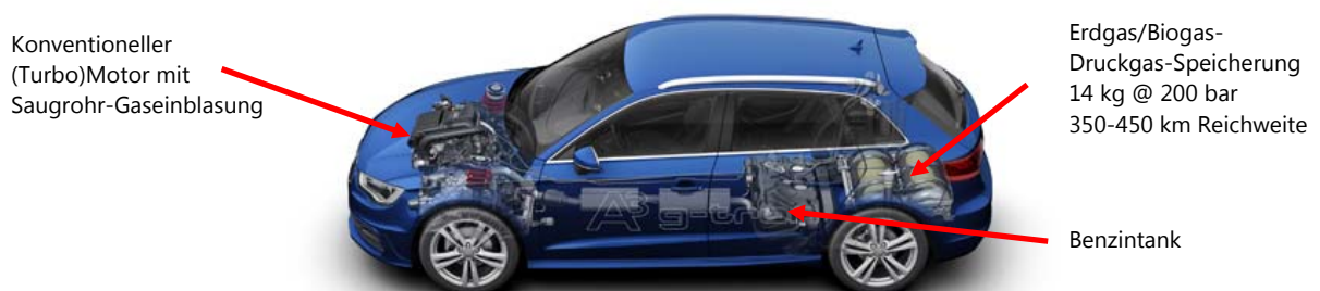
Abb. 5: Beispiel-Erdgasfahrzeug mit üblicher Unterflur-Gasspeicherung (Quelle: Audi, Internet)
