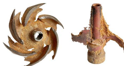
Pumpehjul udsat for slitage og korrosion – undgå dette i tide!
